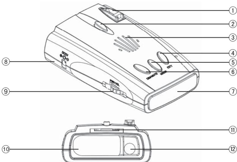
1. Дополнительная линза приёмника сигналов лазера
