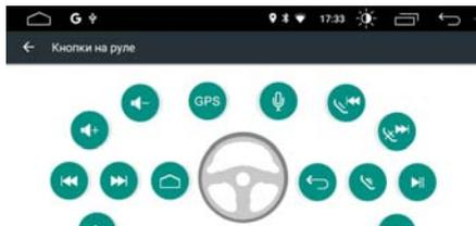
1. Коснитесь иконки, функцию которой необходимо назначить данной кнопке на рулевом колесе. Иконка замигает синим и зеленым цветом.
