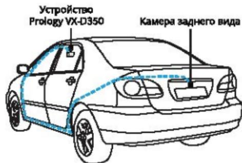
3. Проведите кабель 6 м для подключения задней камеры (входит в комплект поставки) под пластиковыми накладками порогов автомобиля, как показано на рисунке выше. Перед прокладкой примите во внимание, что конец кабеля с красным проводом должен быть подключен к задней камере, а другой конец - к устройству.
